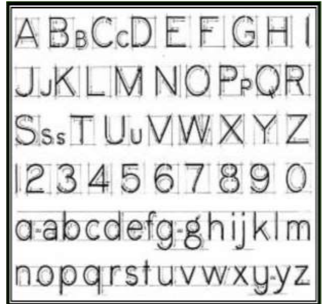
Fig. 3.21: Modelo de Caligrafia Técnica (fonte “Isonorm 3098”)
